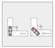
Идеальна для сборки деталей толщиной от 16 мм под прямым углом, толщиной от 19 мм - на ус
