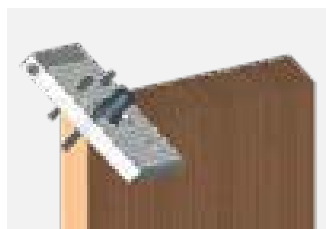
Присадка угловых соединений
