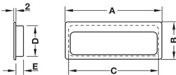
> Montage: schraubenlose Befestigung mit Leimrillen
