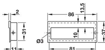
> Werkstoff: Griff: Zinkdruckguss, Rückteil: Stahl
