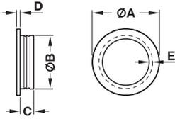
> Montage: schraubenlose Befestigung mit Leimrillen
