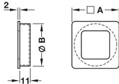
> Montage: schraubenlose Befestigung, zum Kleben
