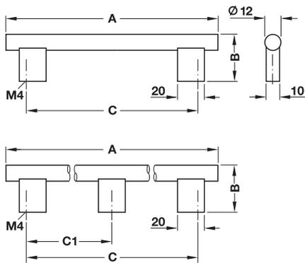
> Ausführung: mit fest montierter Gewindehülse, Sockel lose, Sockelbohrung außerhalb der Mitte, dadurch 2 Möbelgriffvarianten möglich
