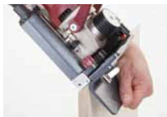
Базирование фрезера по внешней поверхности детали
