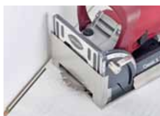
Пиление компенсационных швов
