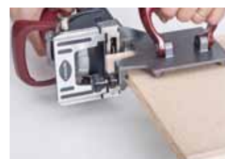
Срезка свесов массивных и пластиковых кромок.
