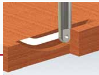
Равномерное нанесение клея по боковым поверхностям паза
