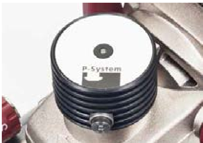
Привод вертикального движения фрезы VMD
