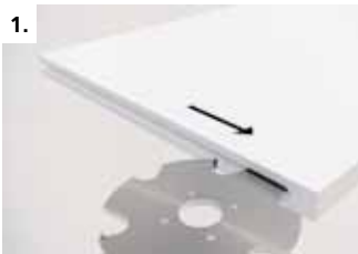
1. Отфрезеруйте продольный паз в полке
