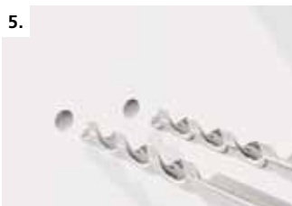
5. Присадите отверстия в боковой стенке
