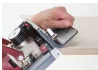
Базирование фрезера по внешней поверхности детали
